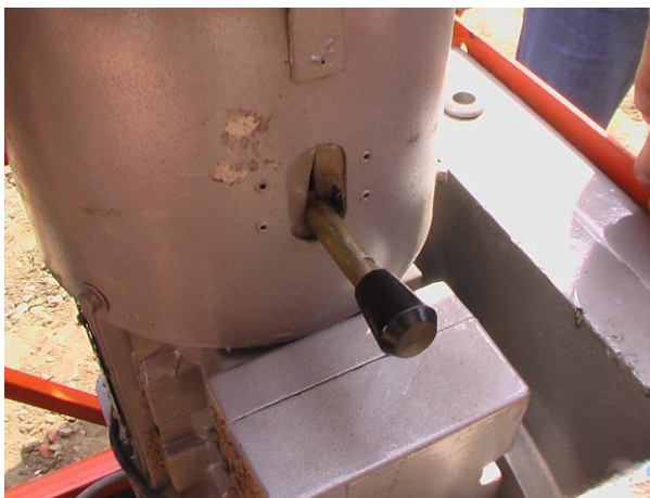
Рисунок 13 – Устройство ручного растормаживания
