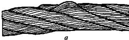
Рисунок 19 – Выдавливание проволок прядей: а — в одной пряди; б — в нескольких прядях
